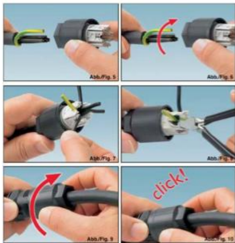
Obrázek 9: Připojení sítě dopravního čerpadla na konektor Quickon
